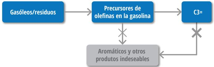
Figura 1: Las reacciones involucradas en la formación del propileno.
